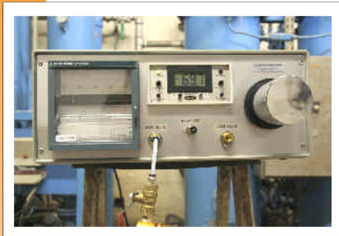
Cette prestation, payante, est réalisée par nos soins, le plus souvent pour le compte de nos distributeurs. L'hygromètre utilisé est de marque SHAW couplé à un traceur monovoie qui produit un graphique sur papier de la mesure effectuée.
